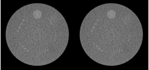
**DLIR-L, CNR: 2.12 DLIR-M, CNR: 2.50 DLIR-H, CNR: 3.04**
